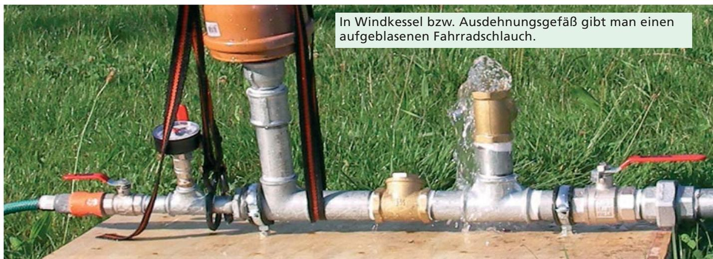
In Windkessel bzw. Ausdehnungsgefäß gibt man einen aufgeblasenen Fahrradschlauch.
